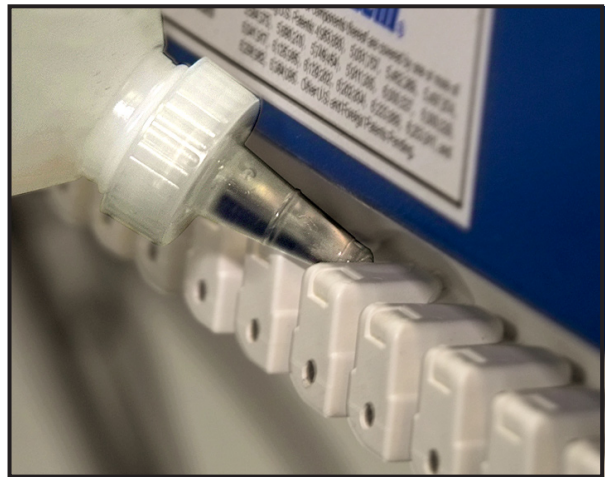
コンベヤ・ウェアストリップをシリコン・オイルで潤滑する
