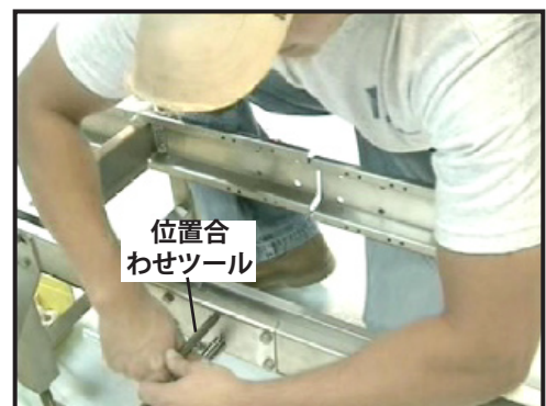
図6:開いているホールに位置合わせツールを挿入し、2つのフレームを近づけます
