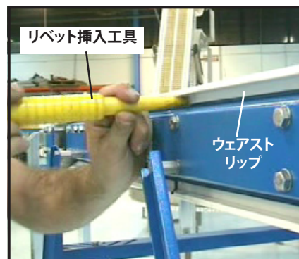
図17:リベットを取り付けてウェアストリップを固定
