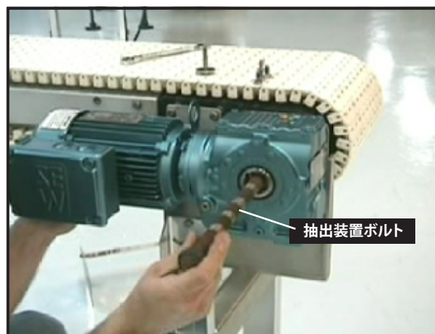
図43:駆動ギアボックスに抽出装置ボルトを差し込む
