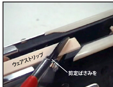
図13:ウェアストリップを60度で切断
