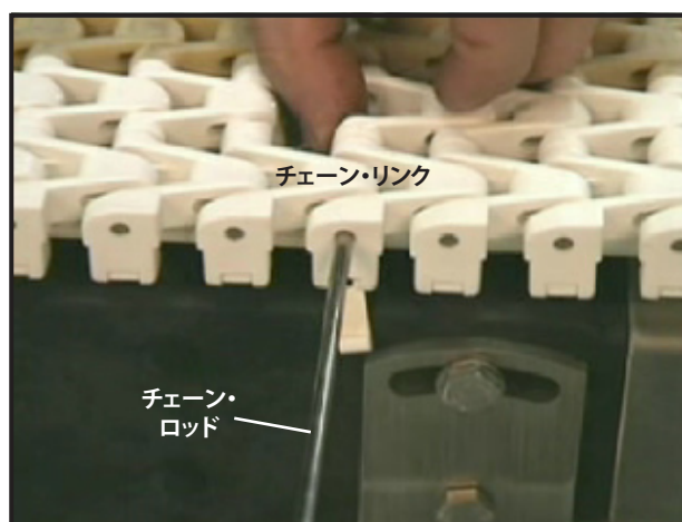
図31: リンクからチェーン・ロッドを挿入
