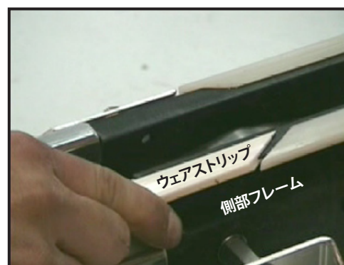
図14:ウェアストリップを側部フレームに差し込む
