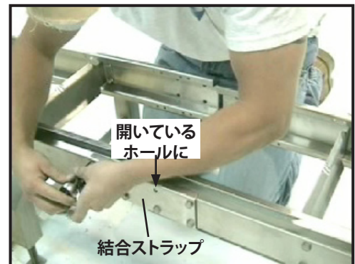
図5:4つの取付ボルトを挿入して締め付け
